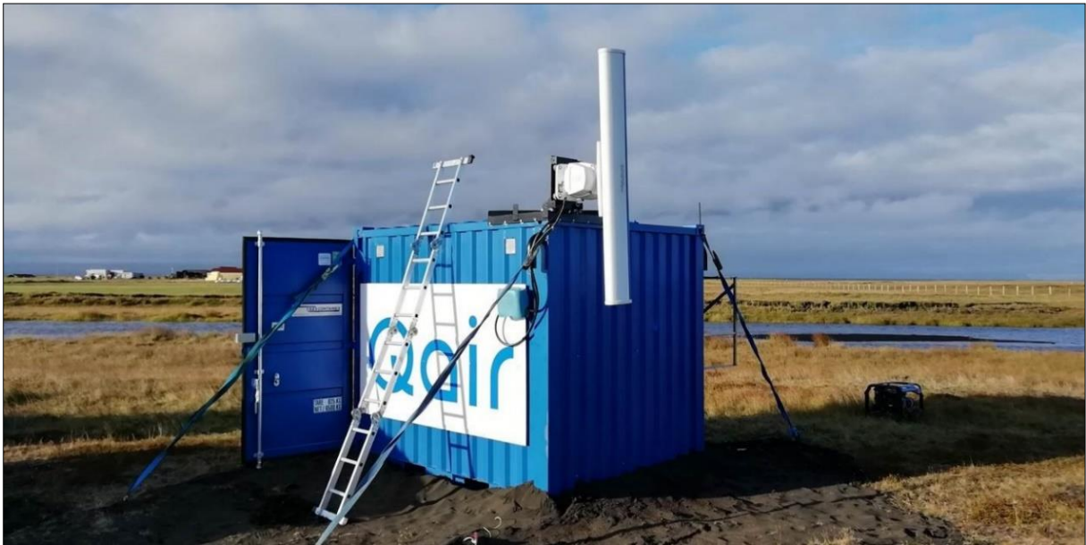
Mynd 5.8 Ratsjá uppsett í lóðréttri stillingu á framkvæmdasvæði.
